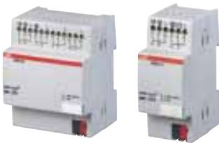
Lüfter-/Fan-Coil Aktoren LFA/S1.1 und LFA/S2.1 wurden zur Einbindung von Klimageräten mit Gebläse in KNX Anlagen entwickelt. Gemeinsam mit Raumtemperaturreglern steuern sie Lüfter und elektrothermische Stellantriebe an. Neben der kostengünstigen Ansteuerung von drei- bis fünfstufigen Lüftern bleiben an den Aktoren freie Ausgänge für Heizung u. a.
